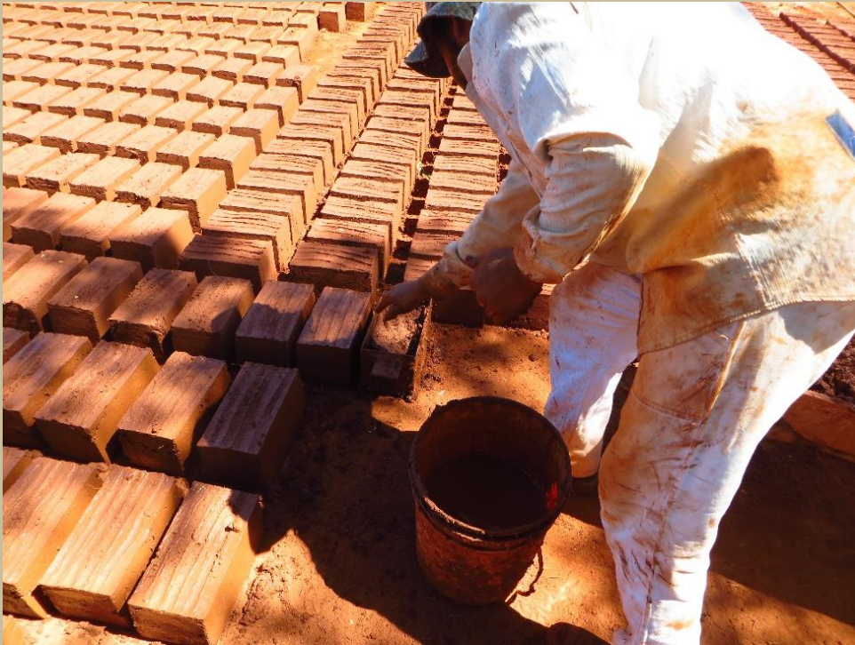
Figura 20 — Produção de um adobe com fôrma metálica.
