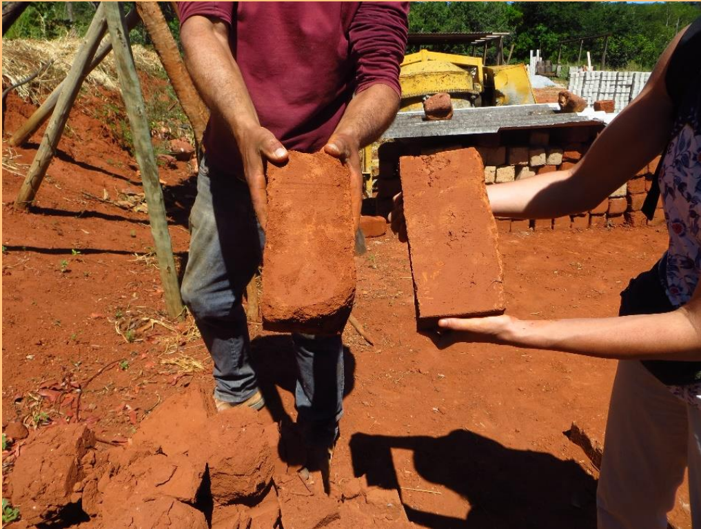
Figura 23 — Diferença entre adobes produzidos com e sem o barro deixado de molho.
