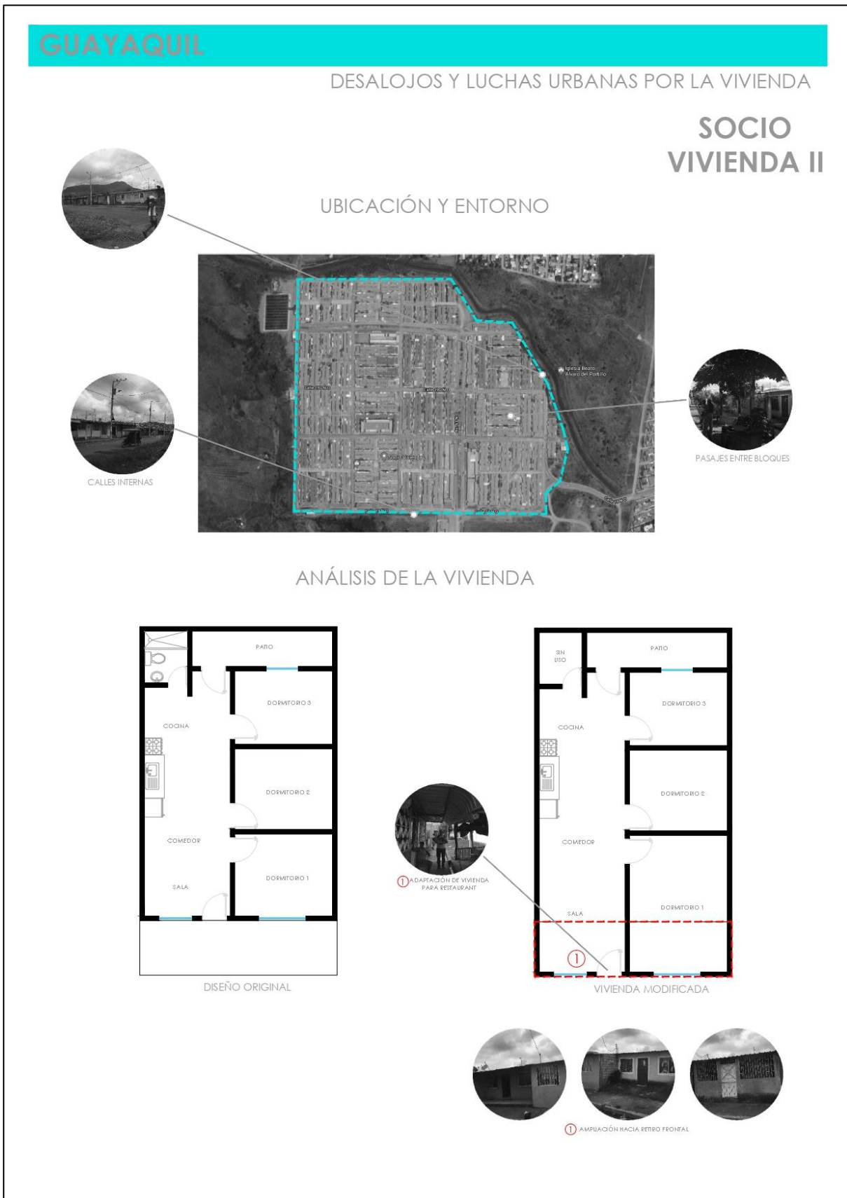
Figura N° 20. Adaptaciones de la vivienda en SocioVivienda 2.
