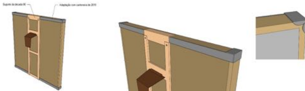
Figura 4 – Representação do suporte das obras da Via-Sacra: à esquerda a montagem do suporte vista pelo verso, observa-se na parte central da obra, em tonalidade rósea, o suporte que foi fixado na década de 1990. No centro, detalhe do suporte e da adaptação feita em 2019, em cinza. À direita, detalhe da cantoneira vista pela frente da obra. Ilustração: Juliano Pflueger para as autoras, 13 jan. 2021.
