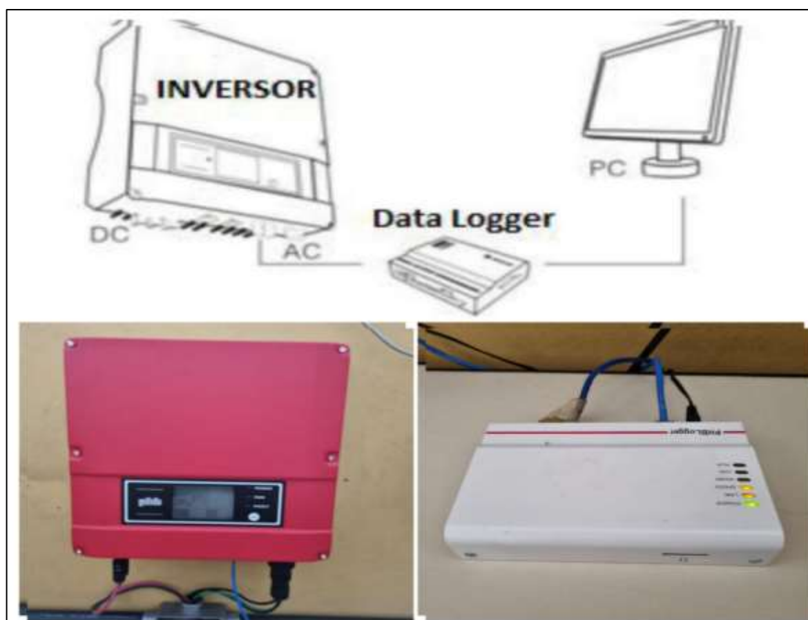
Figura 25 – Esquema ilustrativo da conexão do Data Logger ao inversor e PC.
