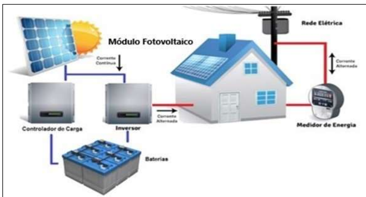
Figura 5 – Sistema fotovoltaico com armazenamento .
