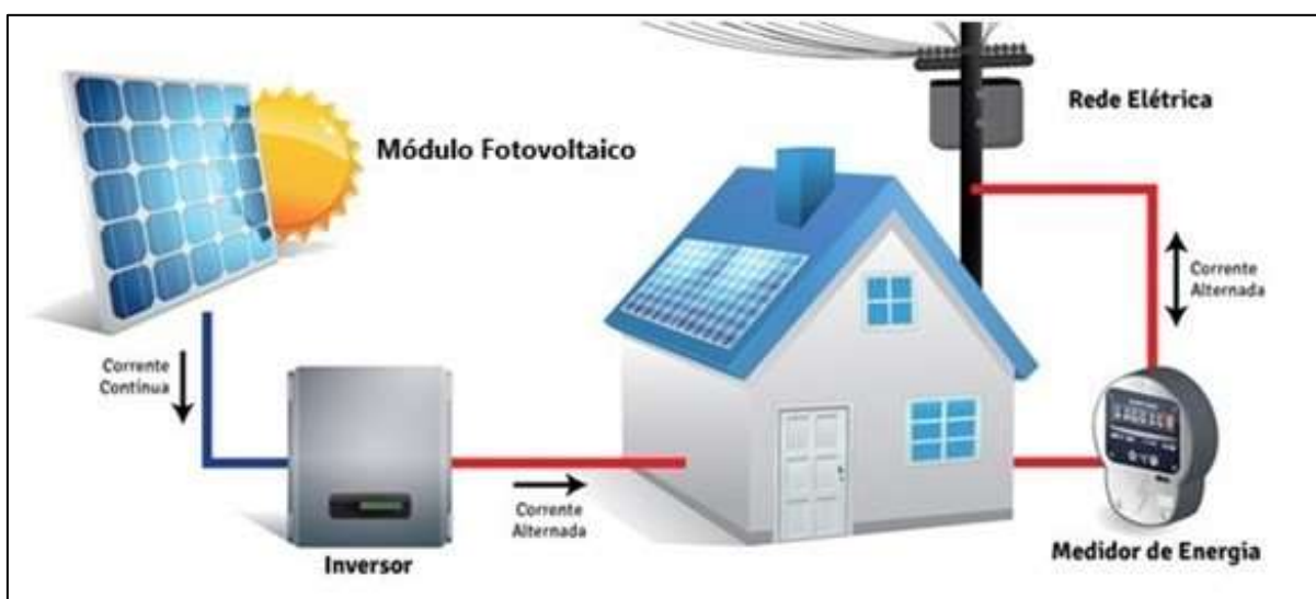
Figura 4 – Sistema fotovoltaico conectado à rede elétrica.
