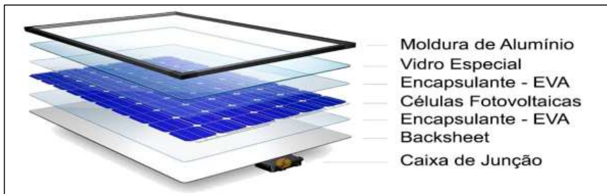
Figura 6 – Composição de um módulo fotovoltaico.
