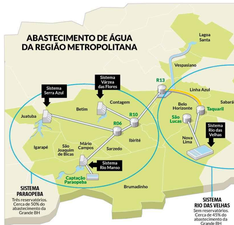
Figura 16 – Sistema Integrado de Abastecimento de Água da Região Metropolitana de Belo Horizonte. Fonte: OLIVEIRA, 2018.
