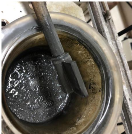
Figura 21 - Polpa da lixiviação de finos da liga com KOH, contendo ferro em suspensão em contato como licor de hidróxido de potássio e nióbio solubilizado
