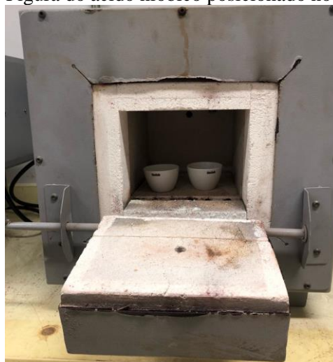
Figura 27 - Figura do ácido nióbio posicionado no forno muffle
