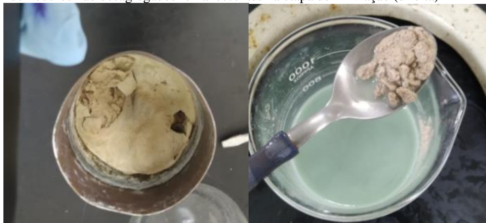
Figura 17 - Foto do produto gerado após etapa de calcinação com presença NaOH (esquerda) e de nódulos não desagregados remanescentes na etapa de lixiviação (direita)
