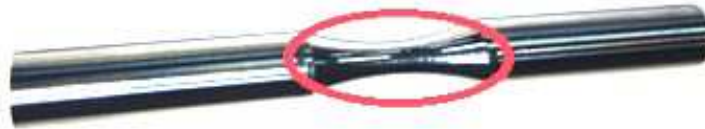
Figura 4.6: Corpo de prova (comprimento de 100 mm) com destaque para região roleteada.
