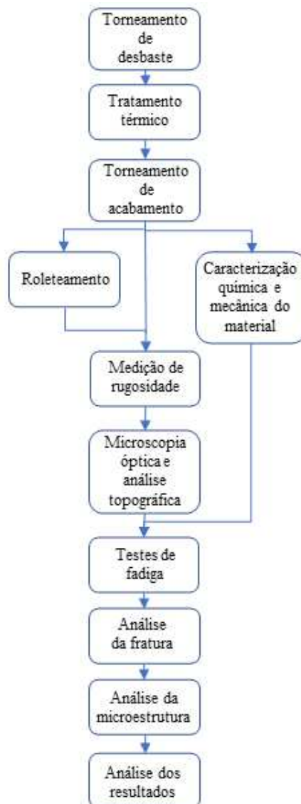
Figura 4.1: Fluxograma da metodologia experimental.
