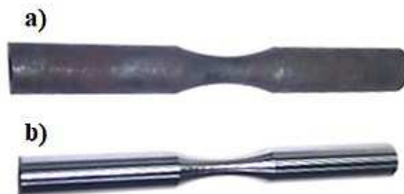
Figura 4.3: Corpo de prova (comprimento de 100 mm): a) após desbaste e b) após do acabamento.
