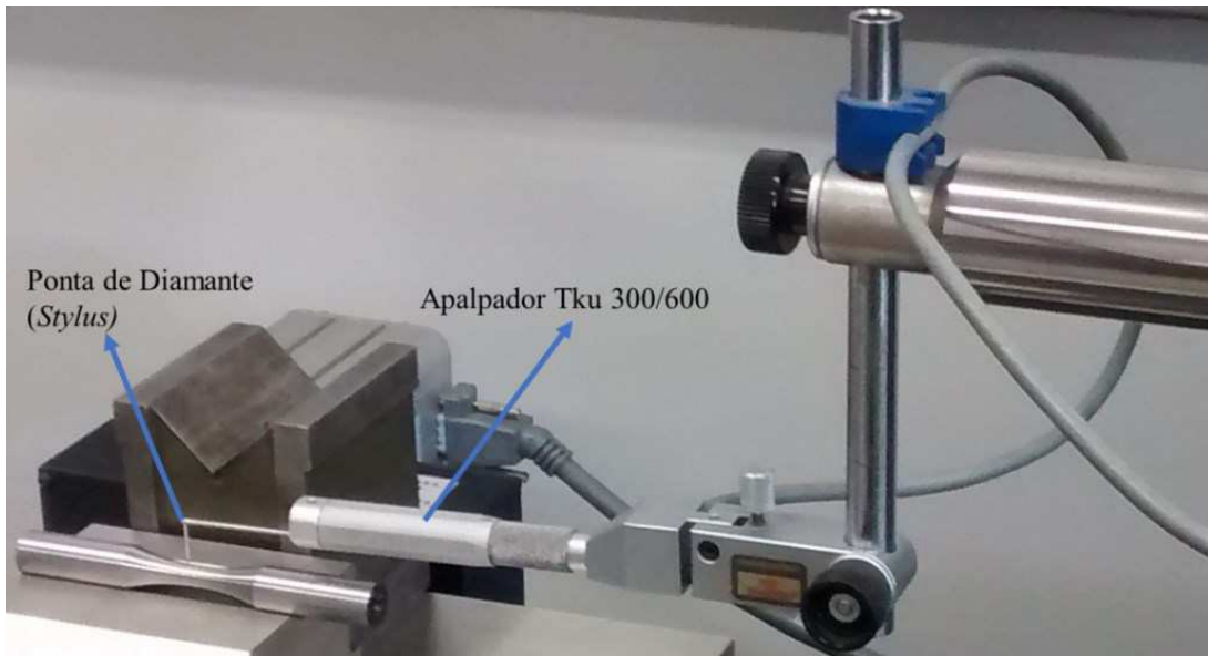
Figura 4.7: Medição de rugosidade no perfilômetro.
