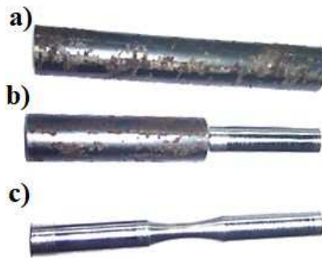
Figura 4.2: Geometria dos corpos de prova (comprimento de 100 mm): a) blanque, b) após o torneamento de desbaste parcial e c) após o término do desbaste.
