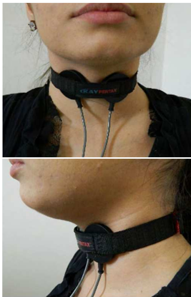
Figura 1. Posição dos eletrodos afixados na nas alas da cartilagem tireóidea no nível das pregas vocais para avaliação eletroglotográfica
