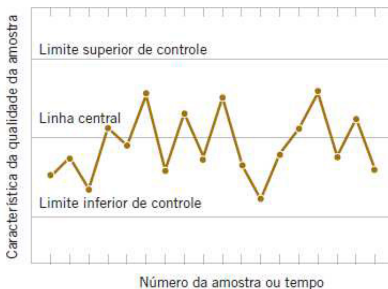
Figura 1.1 - Ilustração de um gráfico de controle (Montgomery e Runger, 2021).
