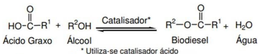
Esquema 1- Reação de esterificação de ácidos graxos
