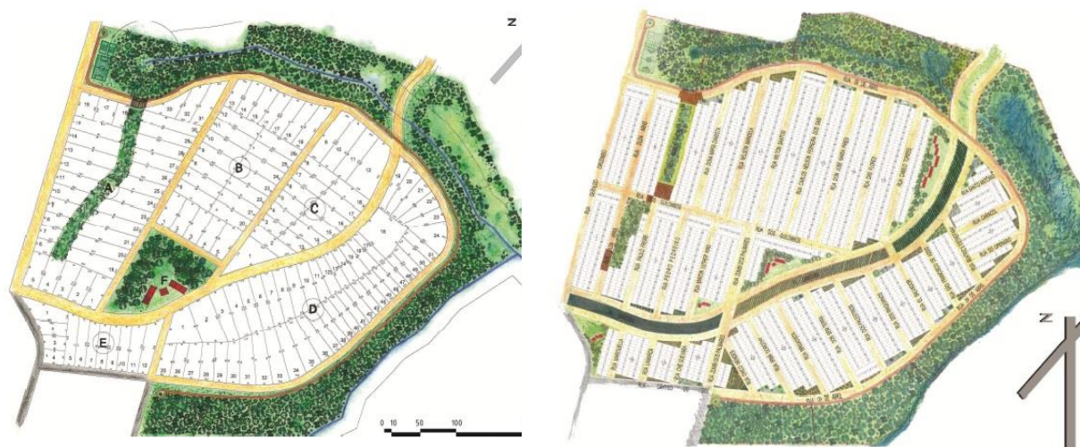
Figura 30 – Plano urbano com lotes coletivos (imagem à esquerda) e plano urbano com lotes individuais (imagem à direita), da Comunidade Dandara.
