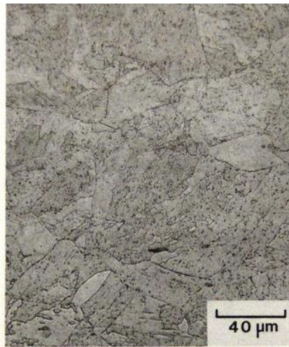
Figura 11: Microestrutura de bainita grosseira, típica de uma chapa de aço 2,25%Cr-1,0%Mo
