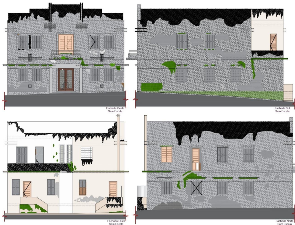
Figura 8 - Fachadas da Residência com patologias. Fonte: Arquivo elaborado pela autora com base no levantamento realizado em 2016 por Jéssica Bortoluzzi e Thaís Ferreira, 28 de abril de 2019.
