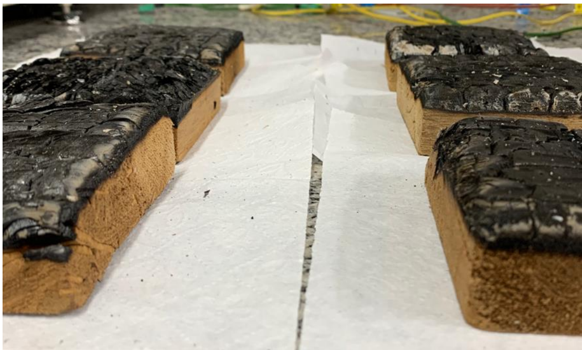
Figura 5 - Estado físico das madeiras tratadas (esq.) e das não tratadas com querosene (dir.). Fonte: Os autores.
