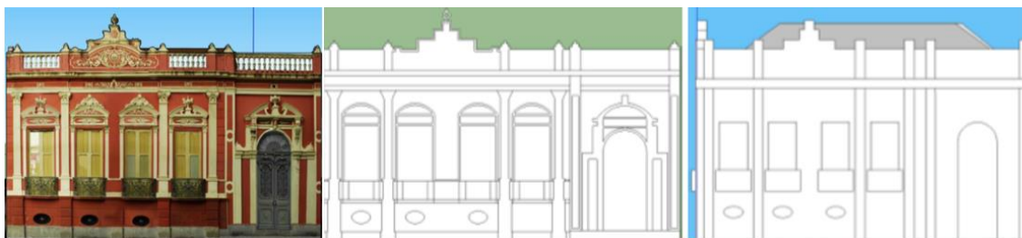
Figura 1 - Simplificações realizadas no Casarão da Família Assumpção. À esquerda, modelo simplificado para a escala 1:75. À direita, modelo simplificado para a escala 1:500. Fonte: NUNES, 2018.
