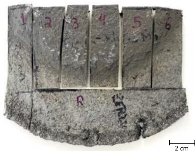
Figura 12: Amostra em cortes da liga CrMnFeCoNi processada pela técnica de conformação por spray.
