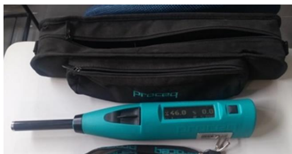
Figura 3 – Esclerômetro PROCEQ utilizado para os ensaios.
