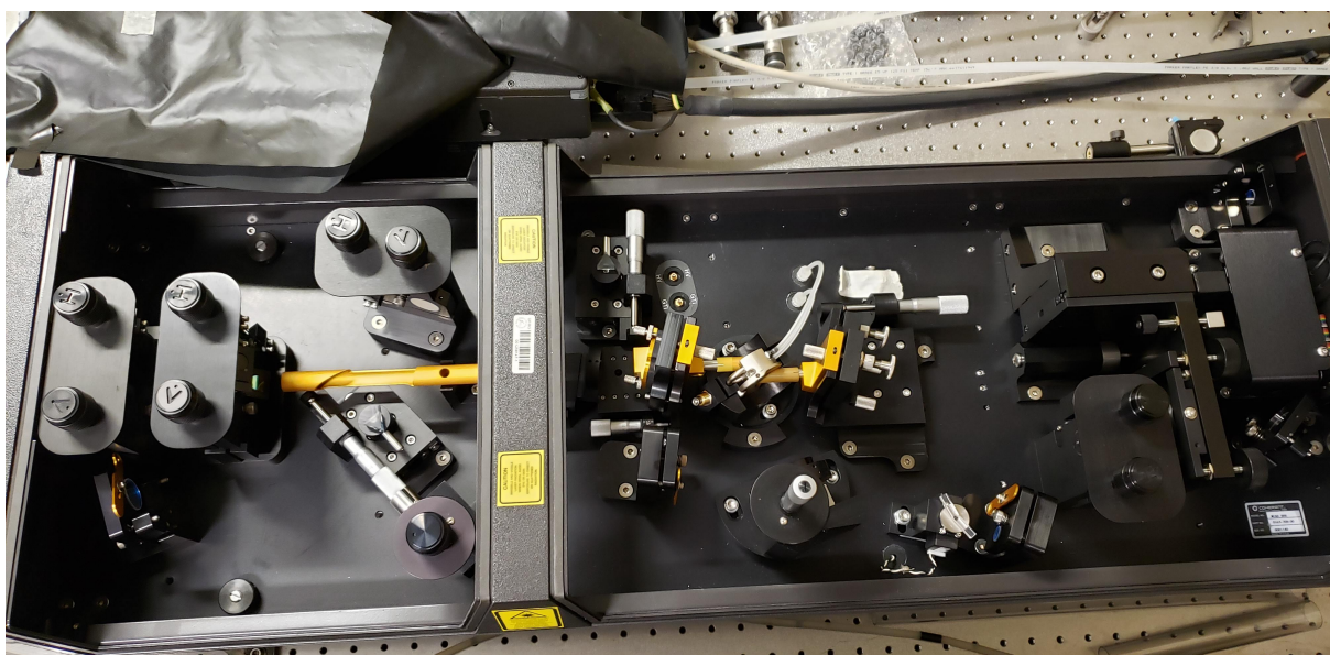
Figura 7 – Estrutura interna laser Mira da Coherent.
