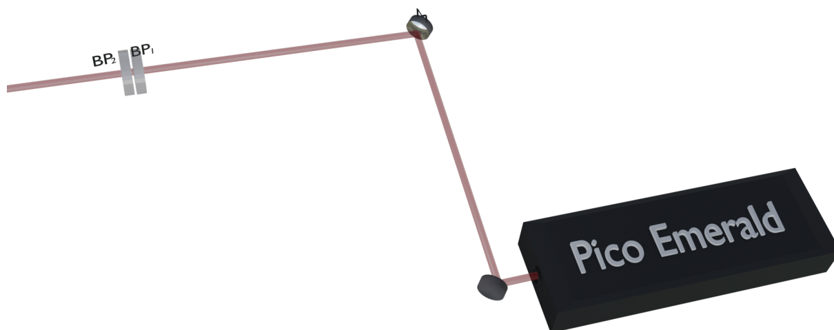
Figura 8 – Fonte de excitação da amostra: montagem ótica. O laser com polarização H emitido pelo Pico Emerald é direcionado ao microscópio ótico por um conjunto de espelhos de prata (M), passando por dois filtro de interferência passa banda ( BP_1 (FF01-786/22), BP_2 ( 785/40)).
