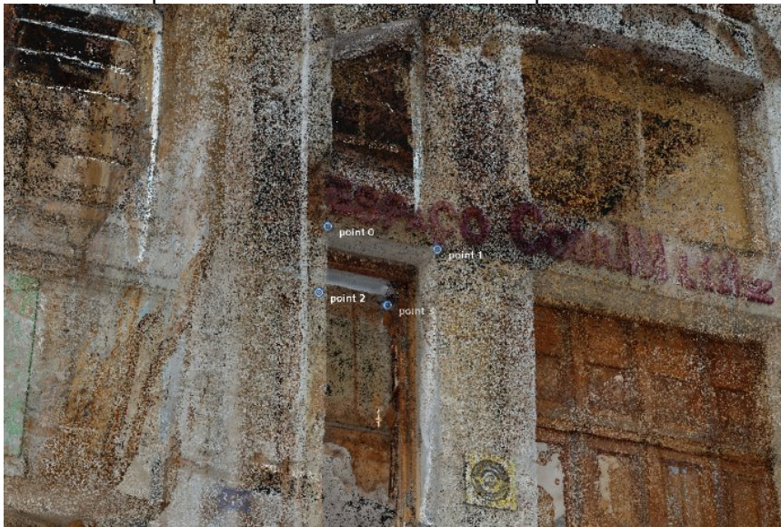
Figura 66 - Nuvem de pontos do ECLE demonstrando 4 pontos de controle adicionados.
