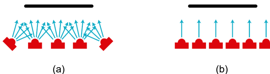
Figura 5 – Esquema ilustrativo exemplificando a posição de tomadas fotográficas para restituição por (a) fotografias paralelas com angulação entre si e (b) fotografias paralelas.
