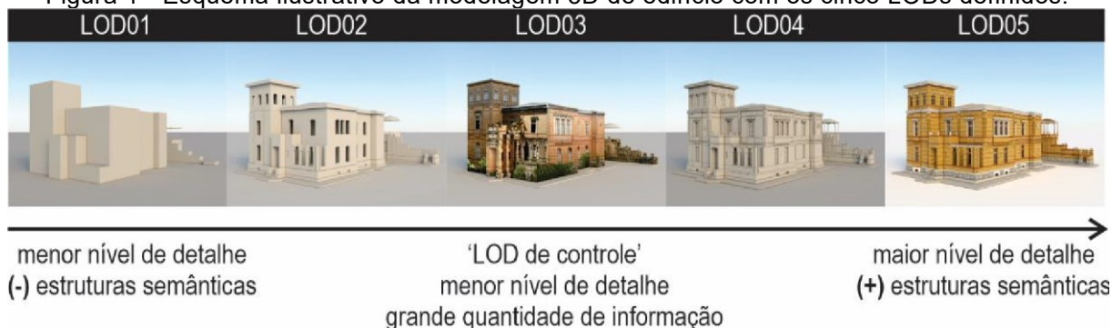
Figura 1 - Esquema ilustrativo da modelagem 3D de edifício com os cinco LODs definidos.
