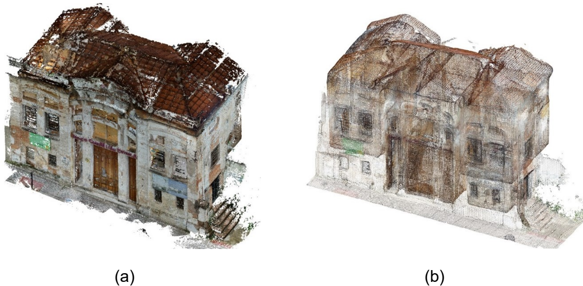
Figura 73 - Perspectivas isométricas externas do ECLE nas nuvens de pontos obtidas por (a) restituição fotogramétrica e (b) escaneamento com Lidar portátil, ilustrando a comparação entre os níveis de densidade dos pontos.
