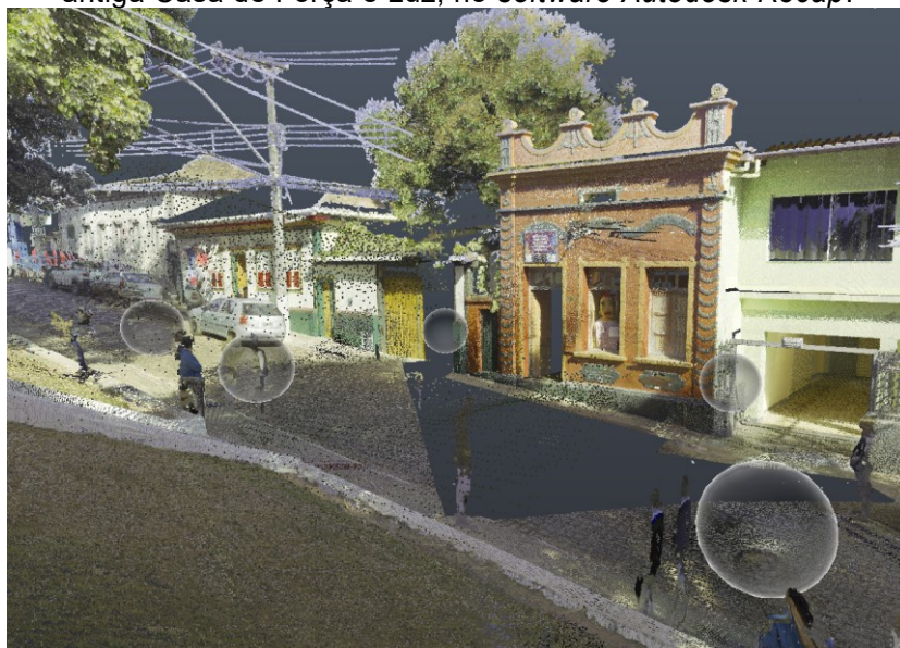
Figura 17 - Visualização da nuvem de pontos completa vista de um dos pontos de varredura, da antiga Casa de Força e Luz, no software Autodesk Recap .
