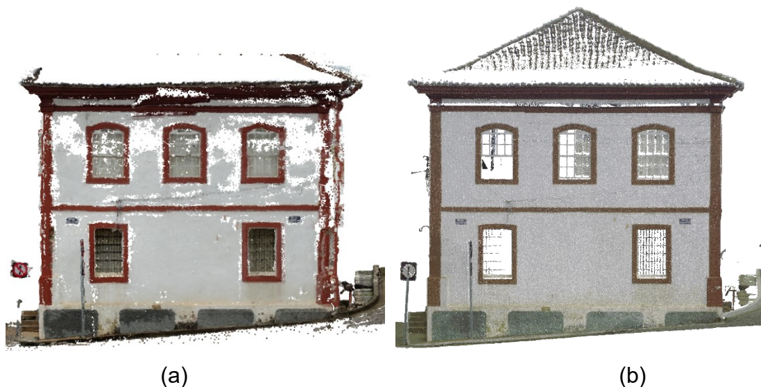
Figura 45 – Elevações de fachada das nuvens de pontos da Cadeia Velha, oriundas de: (a) restituição fotogramétrica, e (b) escaneamento a laser.
