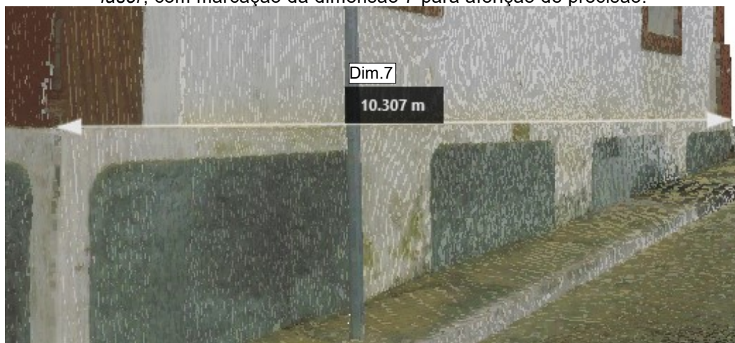
Figura 34 – Perspectiva da nuvem de pontos da Cadeia Velha, oriunda do escaneamento a laser , com marcação da dimensão 7 para aferição de precisão.
