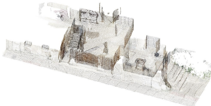
Figura 60 - Perspectiva isométrica da nuvem de pontos capturada pelo aplicativo Scaniverse , com seção horizontal no 1º pavimento, no software Autodesk Recap .
