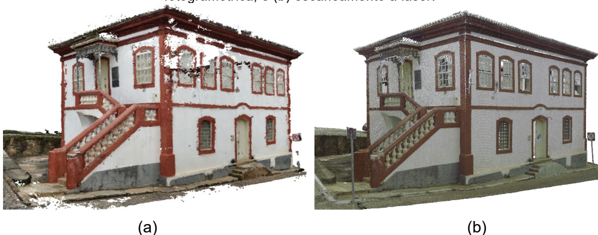
Figura 44 – Perspectivas das nuvens de pontos da Cadeia Velha, oriundas de: (a) restituição fotogramétrica, e (b) escaneamento a laser.
