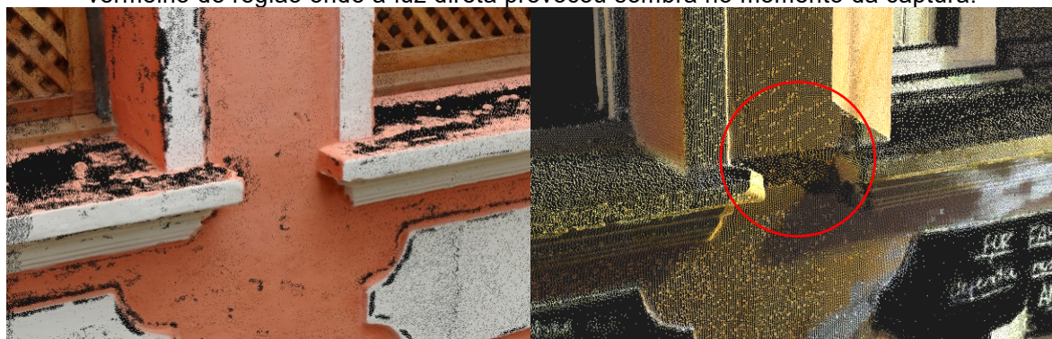
Figura 49 - Perspectivas ampliadas de fachada das nuvens de pontos da antiga Casa de Força e Luz, oriundas de: (a) restituição fotogramétrica, e (b) escaneamento a laser, com marcação em vermelho de região onde a luz direta provocou sombra no momento da captura.
