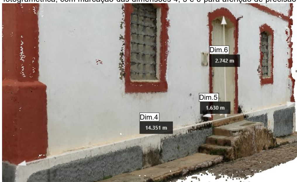
Figura 33 – Perspectiva da nuvem de pontos da Cadeia Velha, oriunda da restituição fotogramétrica, com marcação das dimensões 4, 5 e 6 para aferição de precisão.
