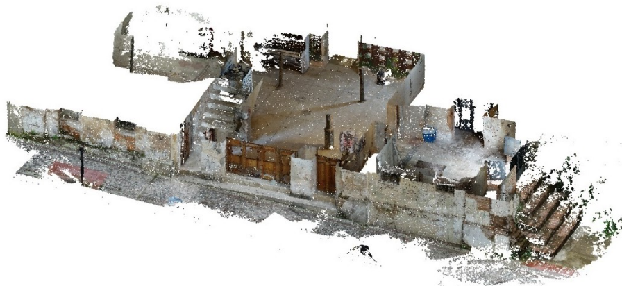
Figura 70 - Perspectiva isométrica da nuvem de pontos obtida por restituição fotogramétrica, com seção horizontal no 1º pavimento, no software Autodesk Recap .
