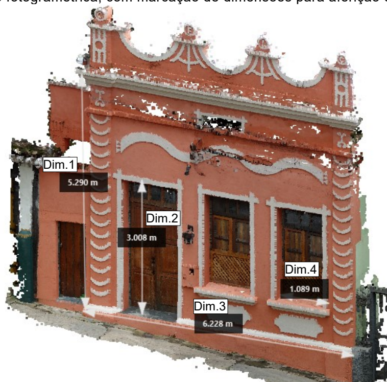
Figura 41 - Perspectiva da nuvem de pontos da antiga Casa de Força e Luz, oriunda da restituição fotogramétrica, com marcação de dimensões para aferição de precisão.
