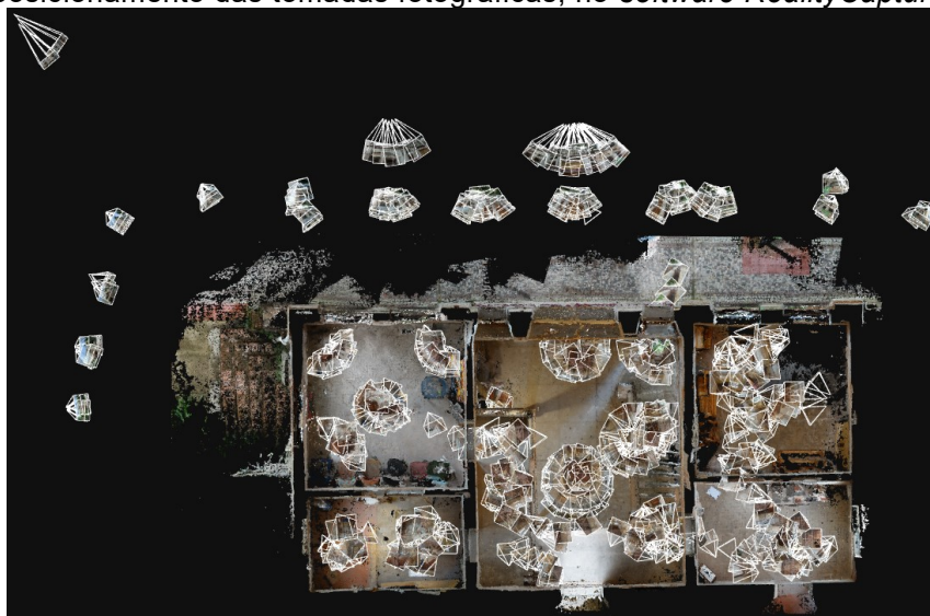
Figura 64 - Nuvem de pontos da restituição fotogramétrica do ECLE, mostrando o posicionamento das tomadas fotográficas, no software RealityCapture .
