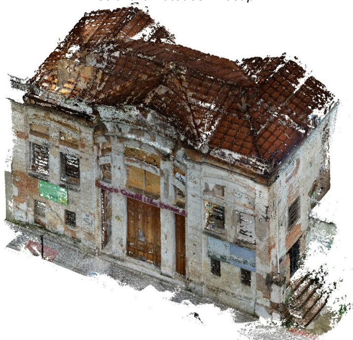
Figura 68 - Perspectiva isométrica da nuvem de pontos obtida por restituição fotogramétrica, no software Autodesk Recap.
