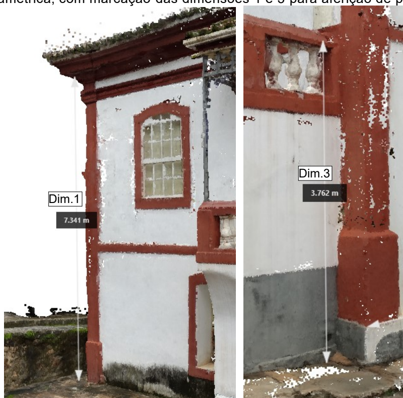
Figura 37 - Perspectivas da nuvem de pontos da Cadeia Velha, oriunda da restituição fotogramétrica, com marcação das dimensões 1 e 3 para aferição de precisão.
