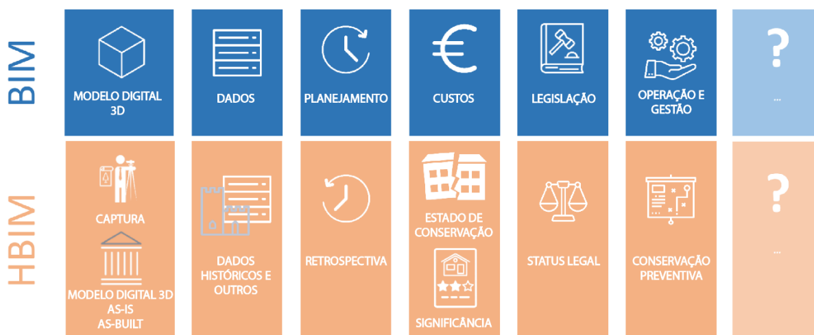
Figura 3 - Descrição comparativa do tipo de informação devida à um modelo BIM para novas edificações e um modelo HBIM.
