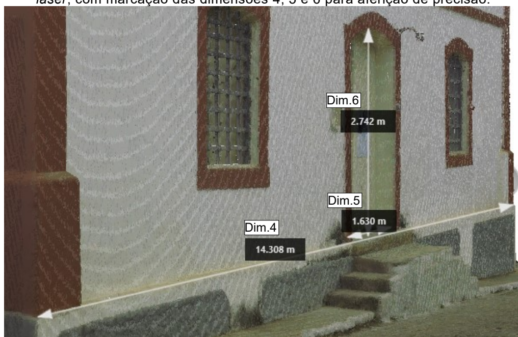
Figura 32 – Perspectiva da nuvem de pontos da Cadeia Velha, oriunda do escaneamento a laser, com marcação das dimensões 4, 5 e 6 para aferição de precisão.
