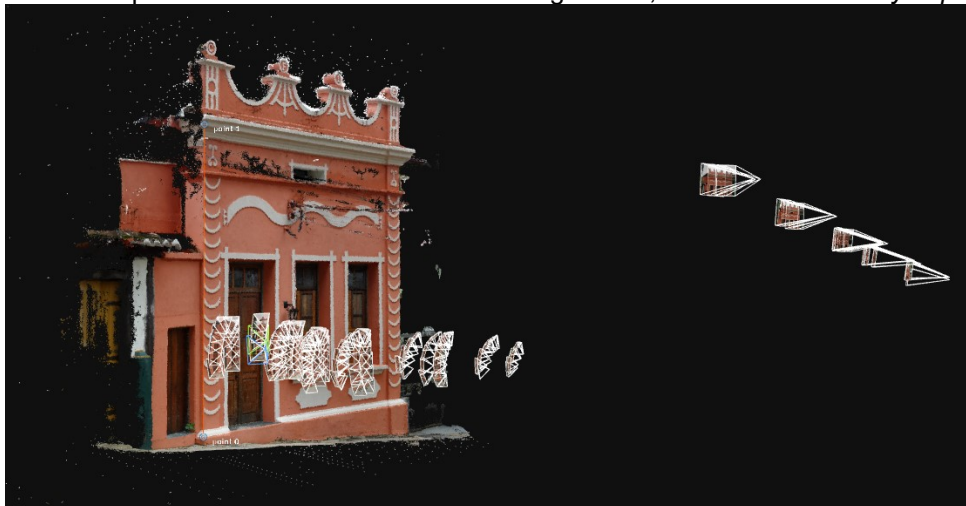
Figura 28 – Nuvem de pontos da restituição fotogramétrica na antiga Casa de Força e Luz, mostrando o posicionamento das tomadas fotográficas, no software RealityCapture .
