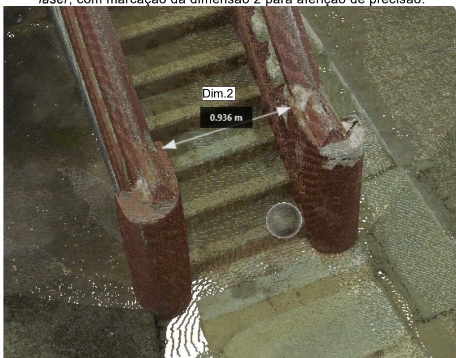
Figura 38 – Perspectiva da nuvem de pontos da Cadeia Velha, oriunda do escaneamento a laser , com marcação da dimensão 2 para aferição de precisão.
