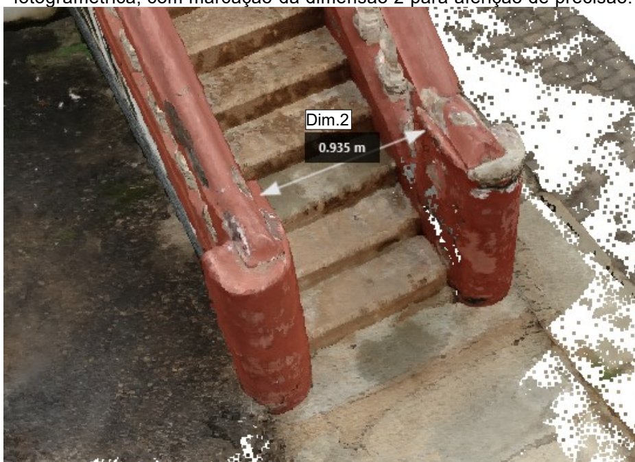
Figura 39 - Perspectiva da nuvem de pontos da Cadeia Velha, oriunda da restituição fotogramétrica, com marcação da dimensão 2 para aferição de precisão.
