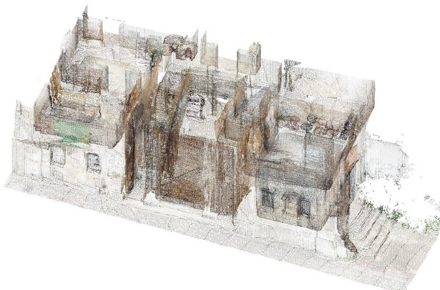
Figura 61 - Perspectiva isométrica da nuvem de pontos capturada pelo aplicativo Scaniverse , com seção horizontal no 2º pavimento, no software Autodesk Recap .
