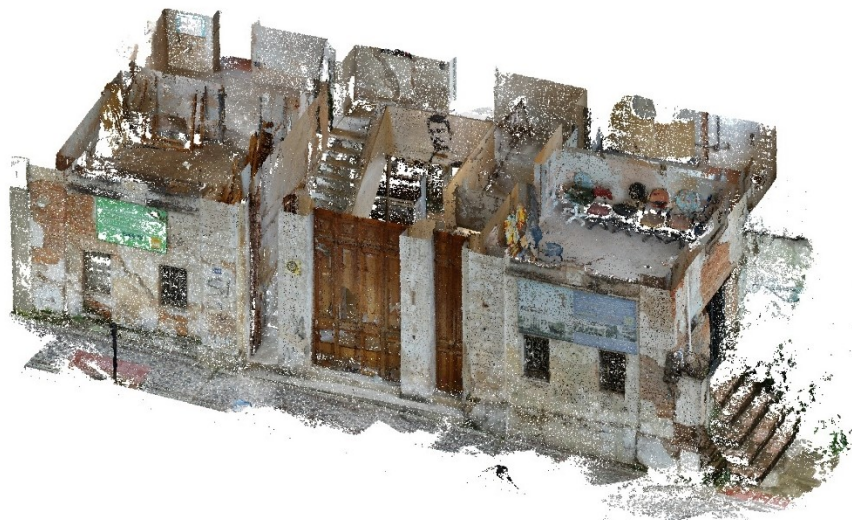
Figura 71 – Perspectiva isométrica da nuvem de pontos obtida por restituição fotogramétrica, com seção horizontal no 2º pavimento, no software Autodesk Recap .
