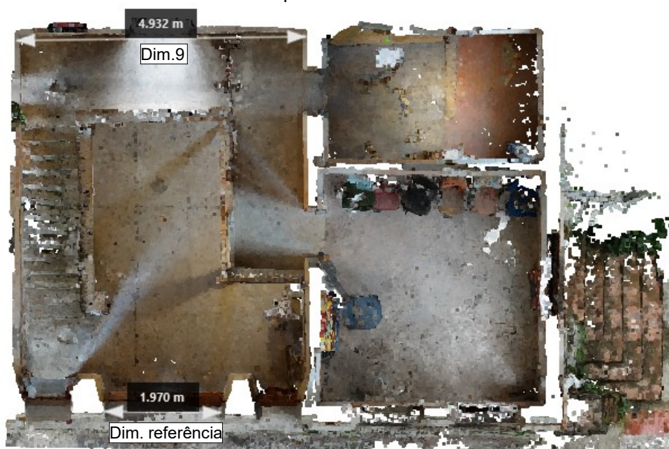
Figura 79 – Seção horizontal do 2º pavimento do ECLE na nuvem de pontos obtida por restituição fotogramétrica, com marcação da dimensão 9 para aferição de precisão, e dimensão de referência utilizada para o controle de escala do modelo.
