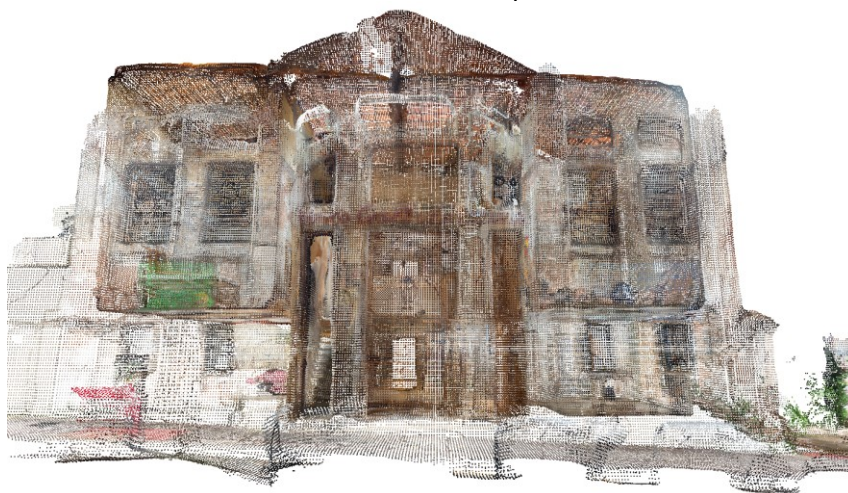
Figura 59 - Perspectiva da nuvem de pontos capturada pelo aplicativo Scaniverse , no software Autodesk Recap .
