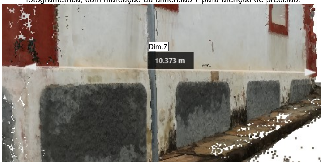
Figura 35 - Perspectiva da nuvem de pontos da Cadeia Velha, oriunda da restituição fotogramétrica, com marcação da dimensão 7 para aferição de precisão.
