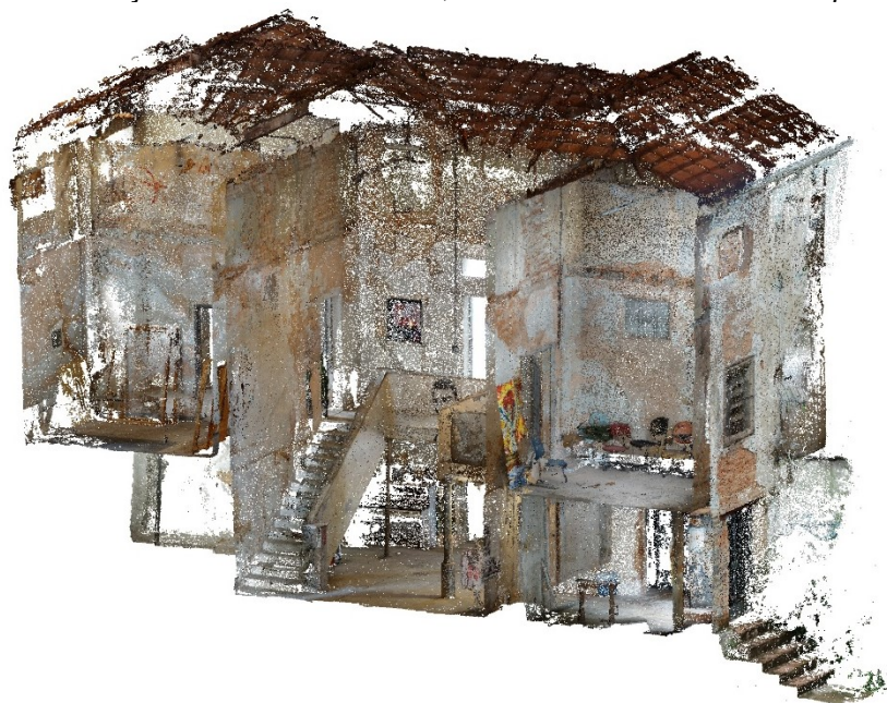
Figura 72 - Perspectiva isométrica da nuvem de pontos obtida por restituição fotogramétrica, com seção vertical transversal, no software Autodesk Recap .
