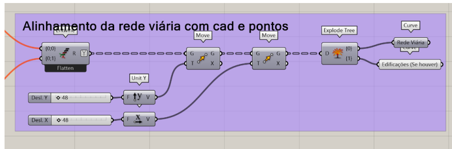
Figura 56: Parte do código para alinhamento da rede viária com o CAD e pontos geométricos.
