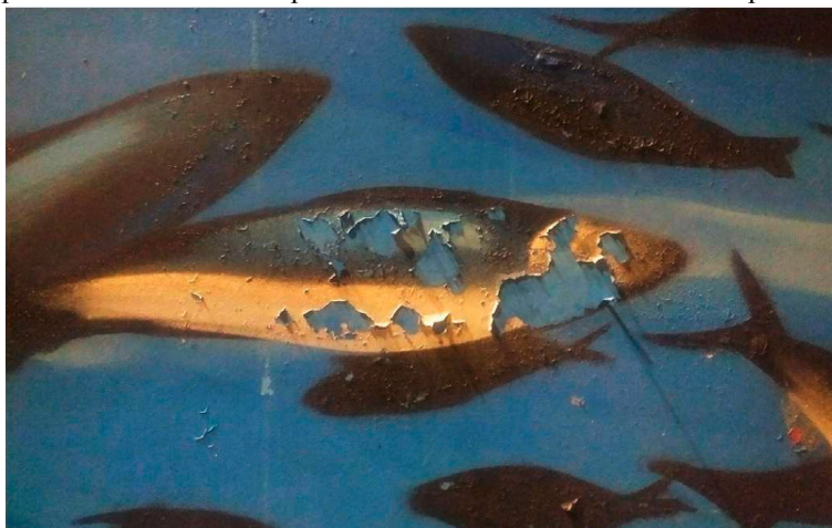
Figura 71 — Desprendimento da camada pictórica em um mural devido a incompatibilidade dos materiais
