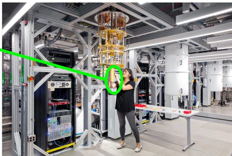
Figura 2 – Pesquisadora trabalhando em um computador quântico supercondutor da IBM. A figura ao lado ilustra um chip de 7 qubits que fica na ponta do aparato. Figura adaptada de: https://newsroom.ibm.com/media-quantum-innovation?keywords=quantum&l=100 .
