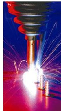
Figura 11 – Cabeça para solda parafuso
