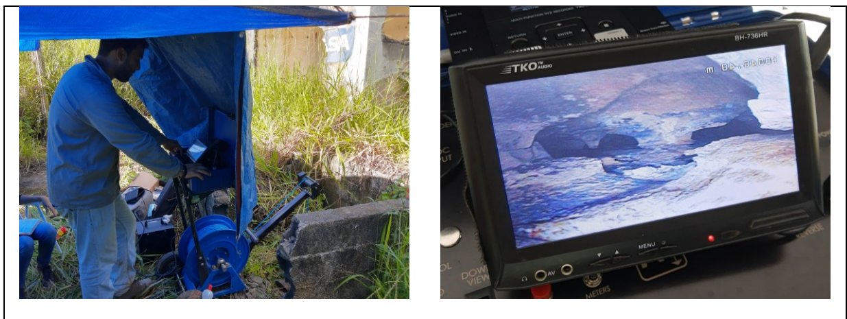
Figura 12: Execução das atividades de perfilagem ótica em campo durante o desenvolvimento do estudo. (Fonte: acervo próprio).
