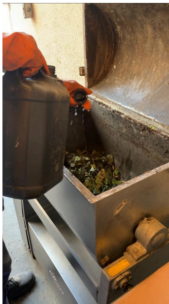
Foto 11 – Profissional adicionando enzima junto ao resíduo orgânico. Fonte: Própria, 2023.
