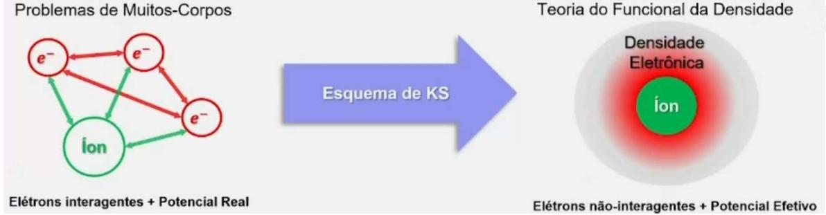
Figura 11 – Analogia do esquema de Kohn-Sham para tratamento de um sistema de muitos corpos, onde as equações de KS como sendo um método em que o estado fundamental de um sistema de elétrons interagente é calculado a partir de um sistema auxiliar de elétrons que não interagem, ou seja, sujeito a um potencial efetivo local
