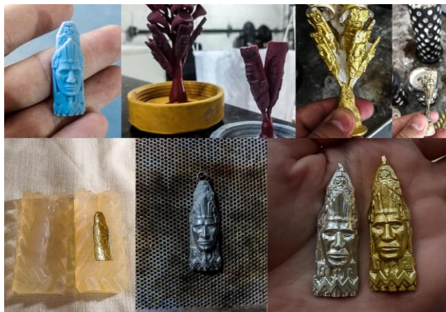
Figura 4. Processo para fundição em metais. O primeiro quadro exibe a impressão 3D em resina. Posteriormente, a árvore de cera. A terceira e a quarta imagens mostram a árvore após a injeção dos metais sendo uma liga simples e de baixo custo, denominada popularmente de moeda e prata respectivamente. Na linha inferior: a borracha, a peça fundida em prata antes do polimento, e, ao final, o par de peças limpas. Fonte: os autores, 2022.
