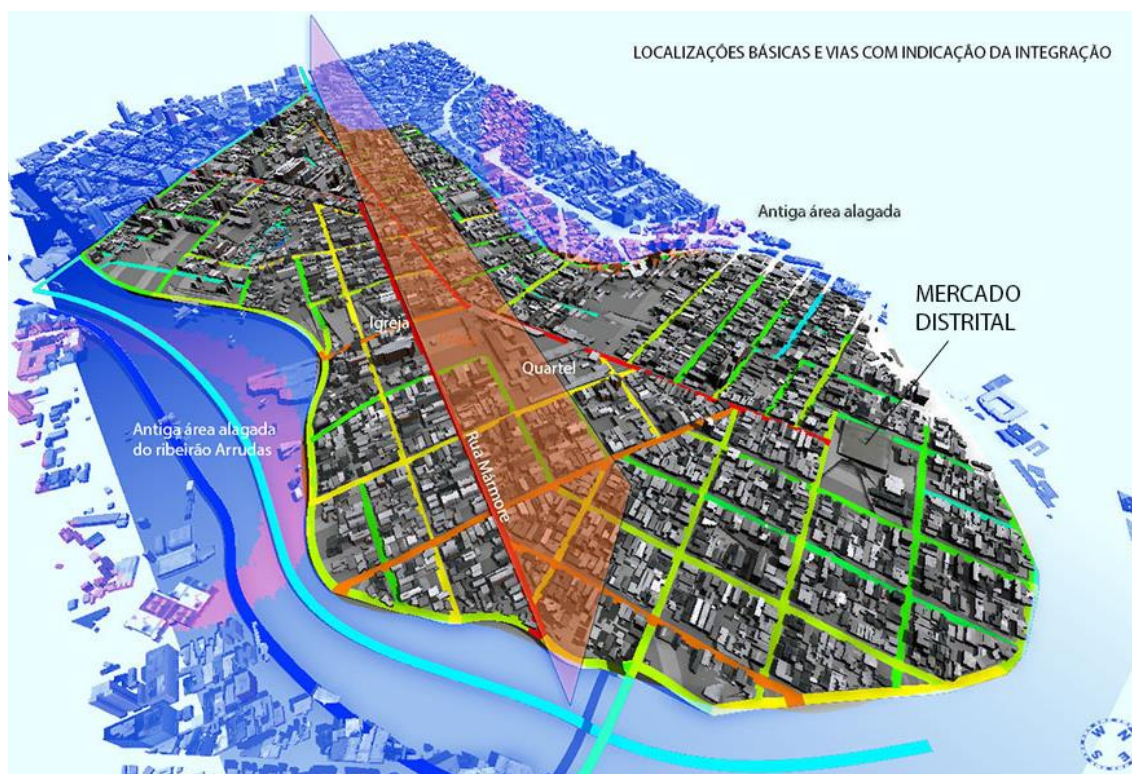
Figura 4: Modelo tridimensional gerado no City Engine™ - Esri ©, com o índice de integração das vias. (Fonte: os autores).
