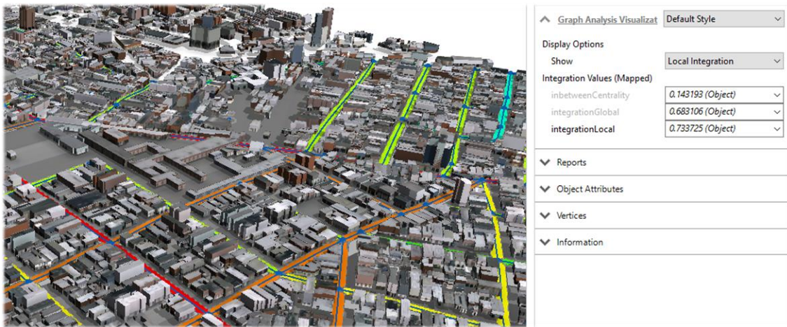
Figura 6: Modelo gerado no CityEngine™ com o cálculo de integração local (Fonte: os autores).
