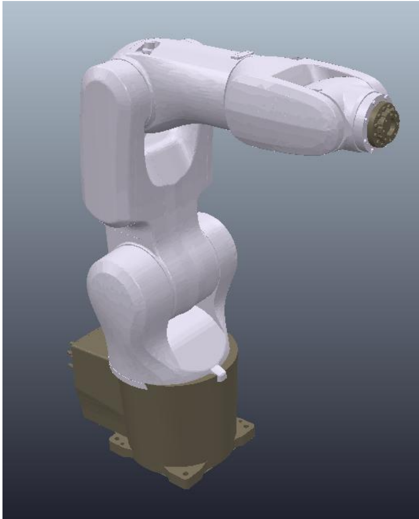
Figura 31 – Modelo do robô KUKA KR4 R600 no simulador CoppeliaSim.
