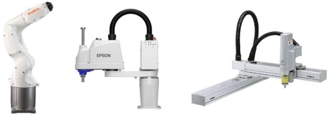
Figura 9 – Robôs comerciais comumente encontrados na indústria. Da esquerda para a direita: KUKA KR4 R600 (articulado), Epson Synthis T3 (SCARA), Yamaha XY-XC (cartesiano).
