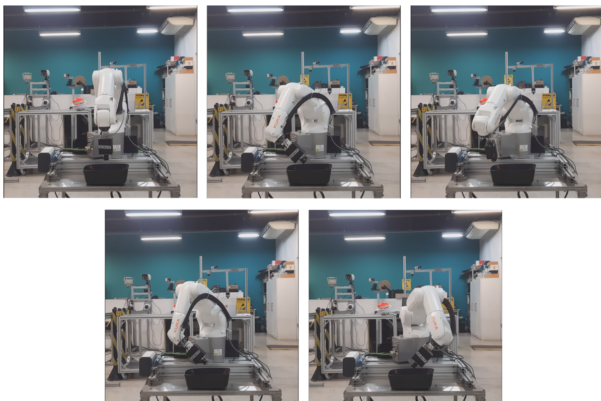
Figura 30 – Execução da inspeção.
