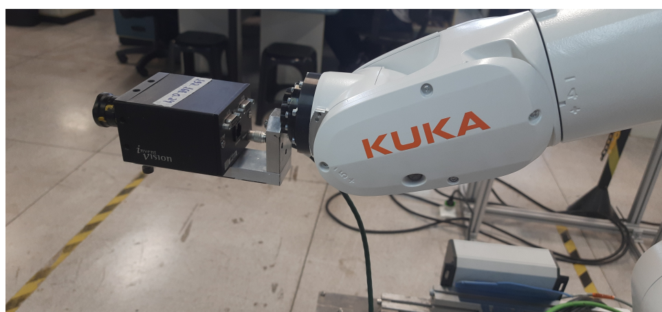
Figura 36 – Montagem da câmera no efetuador do robô.
