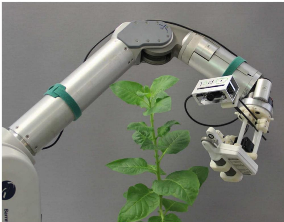
Figura 4 – Configuração eye-in-hand para realização de tarefa relacionada a objeto. Fonte: Alenyà, 2014
