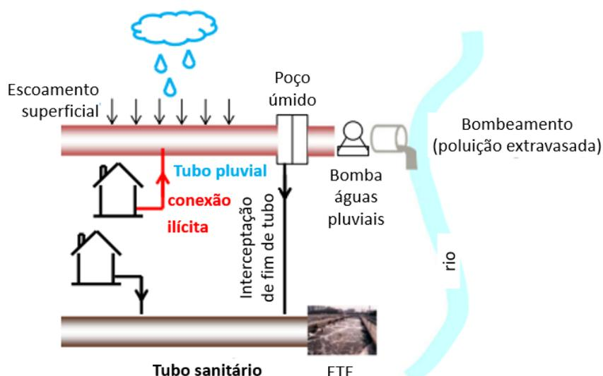
**Figura 71 – Esquema do SSA disfuncional dotado de CTTS em Shanghai, China. Drenagem pluvial e sanitária interligados por interceptação de final de tubo pluvial, dotado de bombeamento para extravasamento.**
