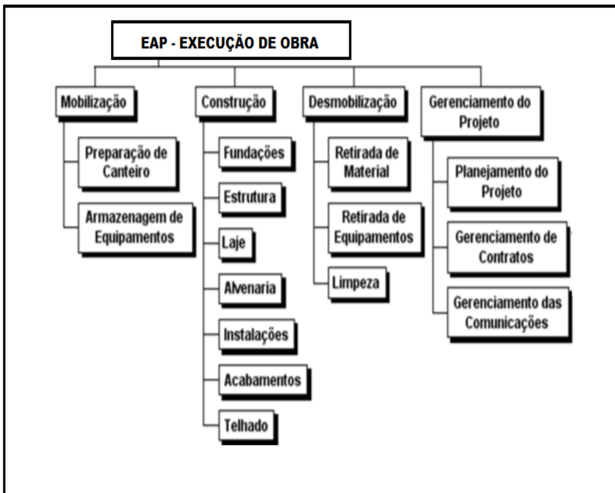
Figura 15 – EAP de execução de obra.
