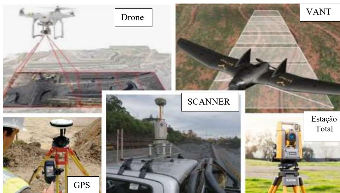
Figura 7: Equipamentos utilizados para levantamento topográfico (contribuição do autor, 2019).
