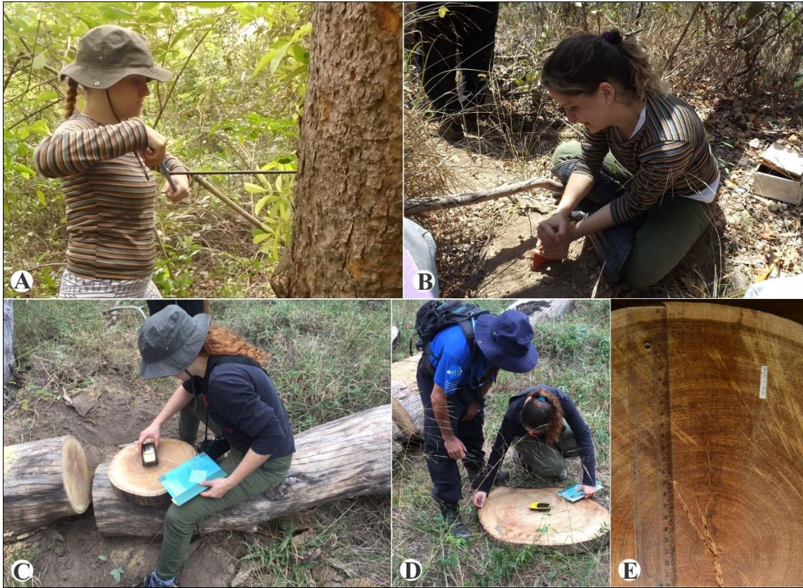
Figura 4. Coletas nas três áreas de estudo. A: amostra da madeira sendo coletada com a Sonda de Pressler. B: coleta de solo. C, D: discos de indivíduos já mortos. E: único indivíduo suprimido (SC10) já polido.
