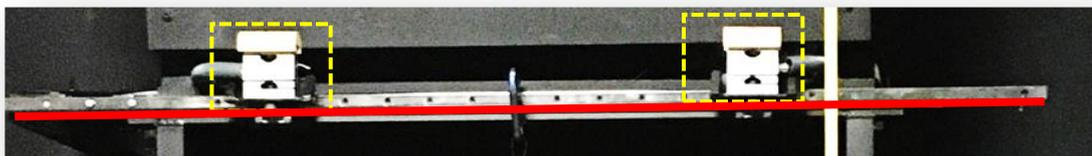
Legenda: Linha vermelha destaca a guia linear que permitiu o ajuste horizontal das agarras. Os quadrados tracejados em amarelo destacam as células de carga.
