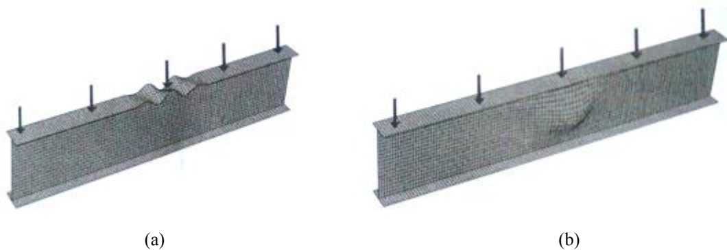
Figura 2.1 - Flambagens locais: (a) flambagem local da mesa comprimida e (b) flambagem local da alma (Fakury et al. , 2016).
