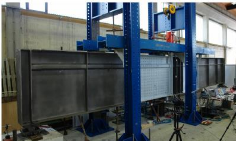
Figura 4.29 - Configuração do ensaio no laboratório para a viga simétrica (Sinur, 2011).
