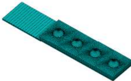
Figura 2.1: Malha de elementos finitos de ligações com múltiplos rebites.
