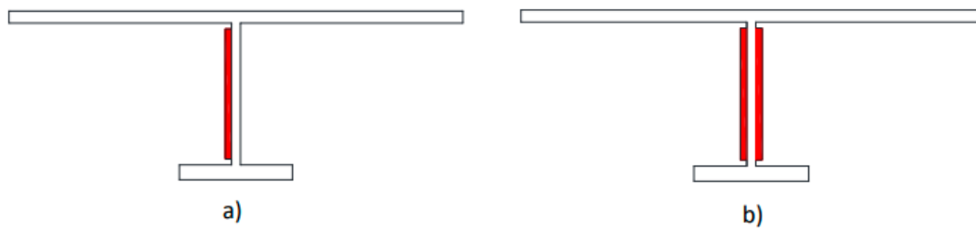
Figura 2.70: Aplicação do FRP considerando reforço (a) simples e (b) duplo
