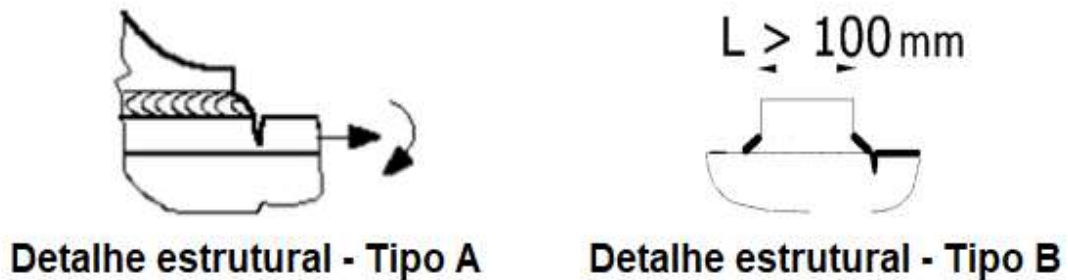
Figura 4.18: Detalhes estruturais (FAT)
