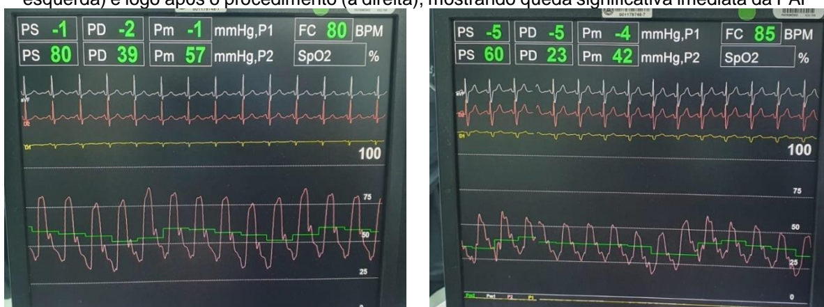
Figura 7 – Registros pressóricos em artéria pulmonar antes da valvoplastia mitral percutânea (à esquerda) e logo após o procedimento (à direita), mostrando queda significativa imediata da PAP
