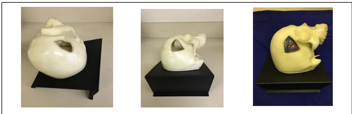
Figura 5 – Crânio produzido em impressora 3D.
