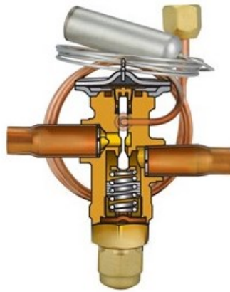
FIGURA 4. Válvula de expansão termostática (representação). Fonte: Danfoss® (2023).
