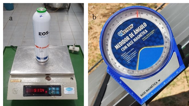
FIGURA 23. (a) Balança digital de precisão; (b) Inclinômetro analógico base magnética.
