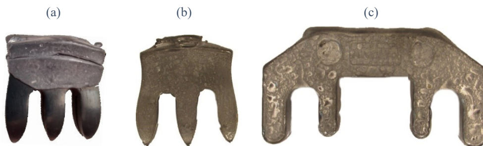
Figura 3.19 – (a) Surdina de ébano menor parcialmente enxertada com chumbo (sdEb/Cb) e réplicas de chumbo da (b) surdina de ébano menor (repChbsdEb1pq) e do (c) abafador de metal revestido de borracha (abfMt2).
