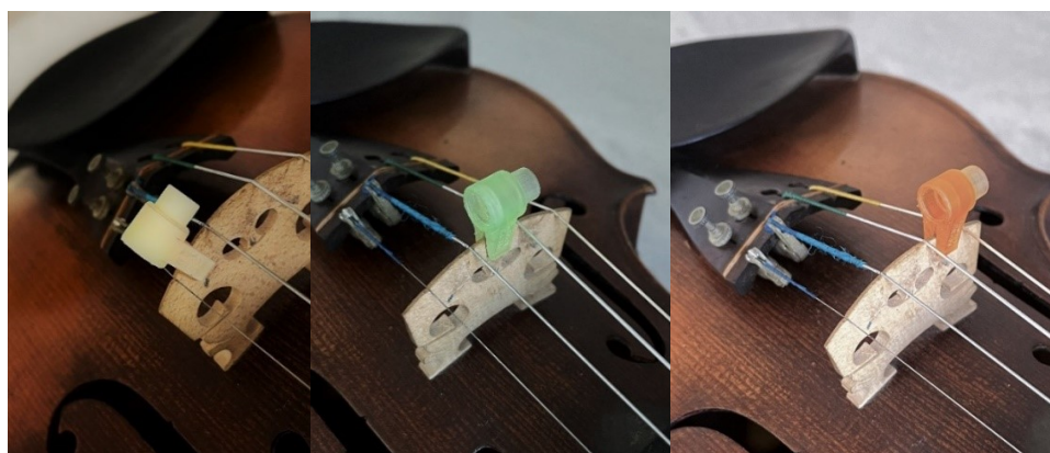
Figura 5.8 – Configuração com um módulo em resina do protótipo em três posições de uso.
