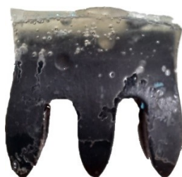
Figura 4.17 – Surdina de ébano menor parcialmente enxertada com resina epóxi (sdEb/Epx).
