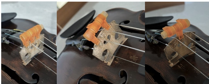
Figura 5.10 – Configuração com três módulos em resina do protótipo em três configurações de uso, com três, dois (laterais) e um dente (central), a entrarem em contato com o cavalete.
