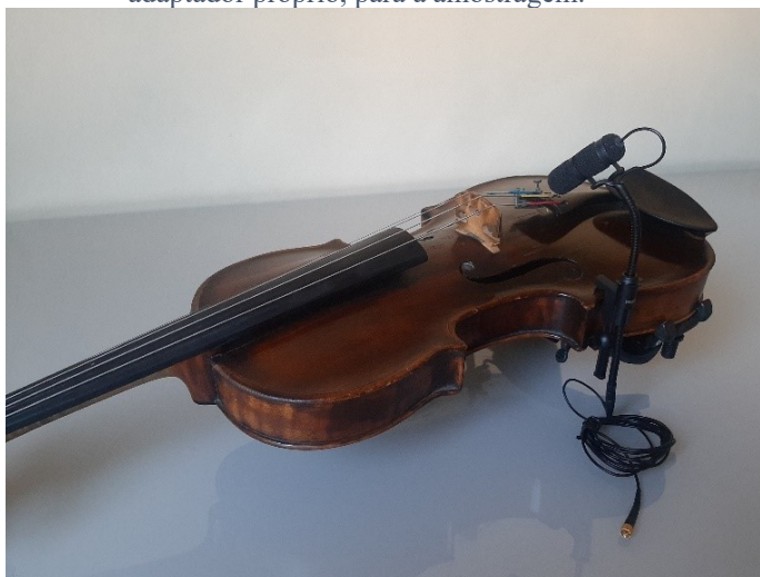
Figura 3.28 – Microfone DPA posicionado no instrumento, por meio do adaptador próprio, para a amostragem.
