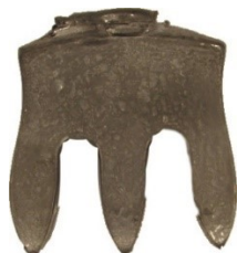
Figura 4.16 – Réplica de chumbo da surdina de ébano menor com três dentes ( repChbsdEbpq ).
