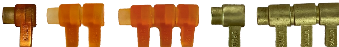
Figura 5.6 – Imagens, em tamanho real, de montagens com um, dois e três unidades de resina impressa em 3D e com uma e três unidades de metal da surdina modular multifuncional.
