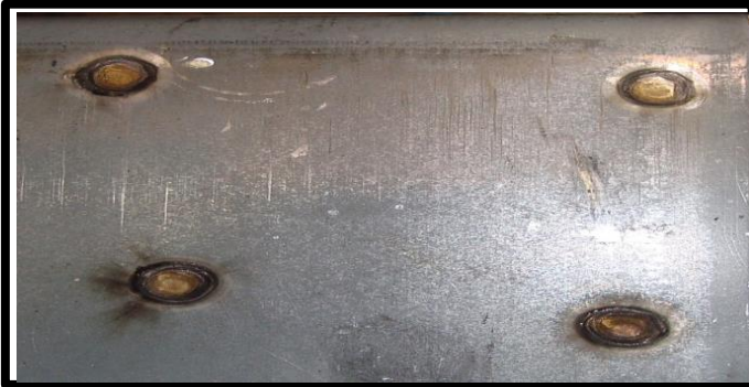
Figura 7 – Cobre deixado na chapa de aço
