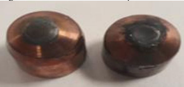
Figura 8 – Face do eletrodo em processo de degradação
