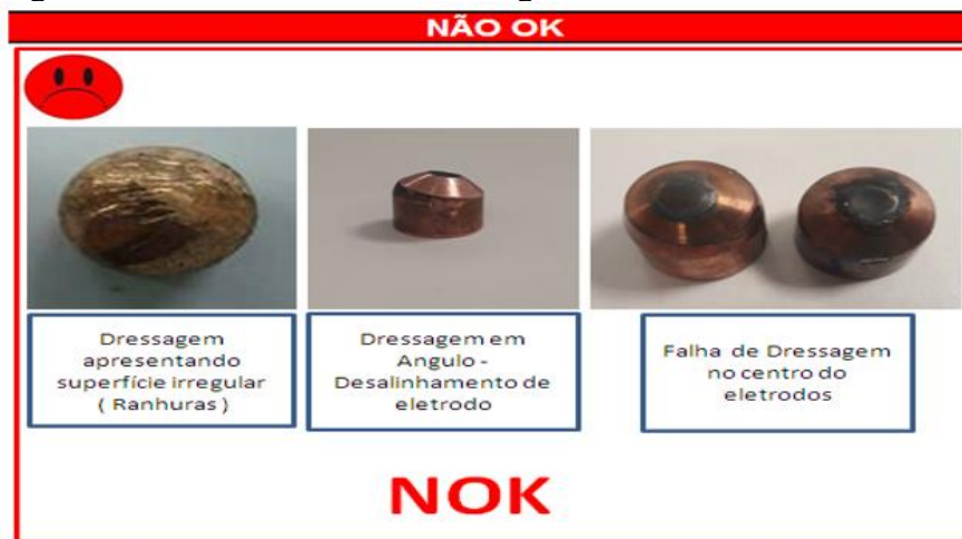
Figura 12 – Efeitos da falha de fresagem
