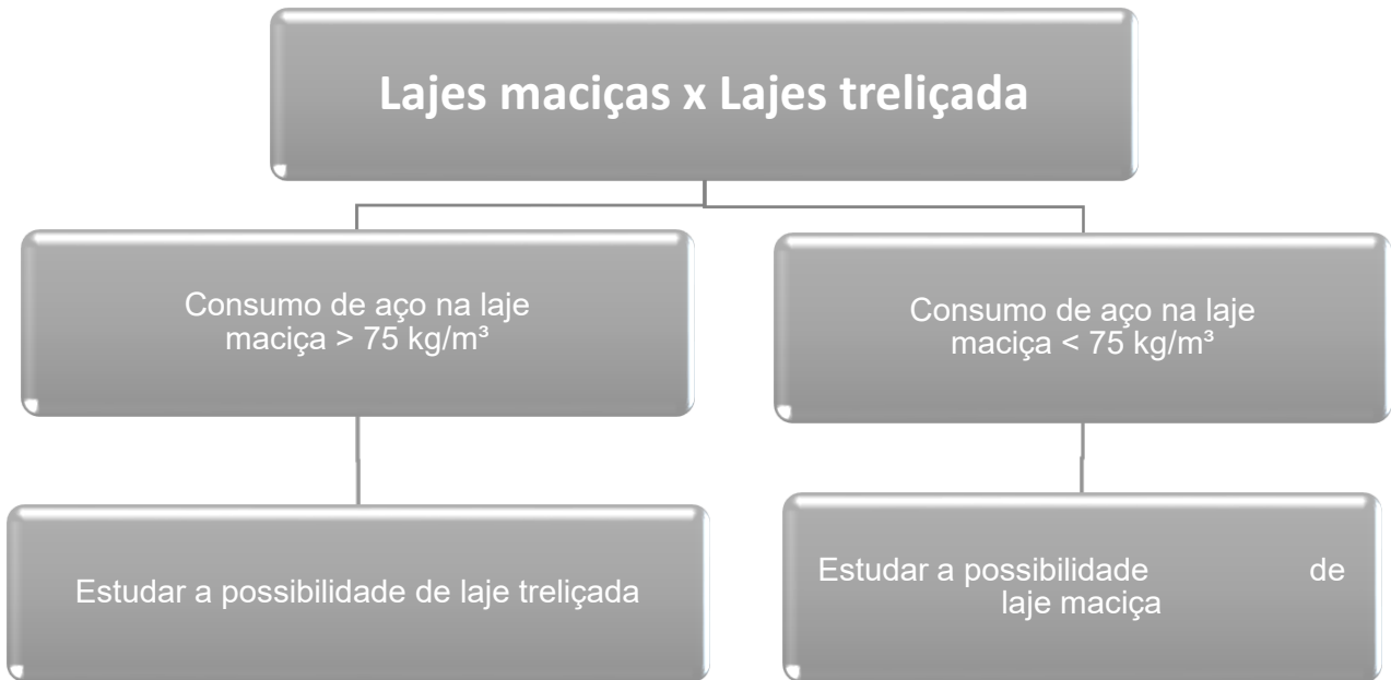
Figura 46 – Diagrama de orientação para confecção de fôrmas para lajes maciças e lajes treliçadas
