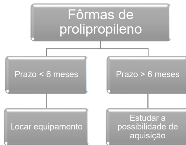
Figura 17 Diagrama de orientação para confecção de fôrmas para lajes com cubetas de polipropileno
