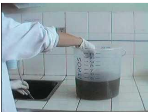
FIGURA 4.12 - Remoção do sobrenadante após o período de sedimentação. (procedimentos "a" e "b")
