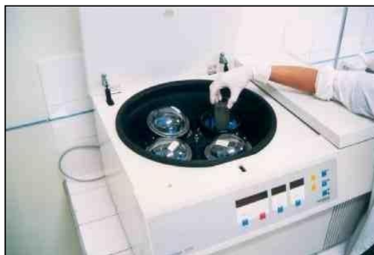
FIGURA 4.13 - Concentração da amostra por centrifugação (procedimentos "d" e "g")
