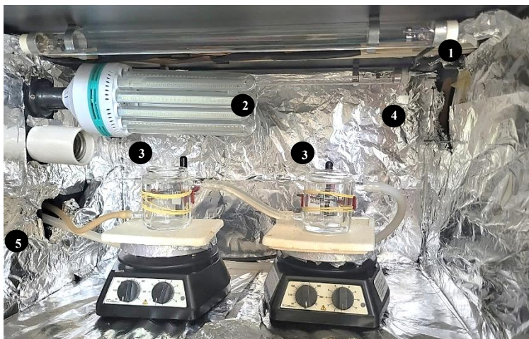
Figura 12. Foto do interior da câmara ultravioleta-visível utilizada nos testes fotocatalíticos e identificação dos seus principais componentes, em que 1 = lâmpadas UVC; 2 = lâmpada de LED; 3= reatores catalíticos; 4 = ventilação/ entrada de ar; 5 = entrada e saída de água do banho termostático.
