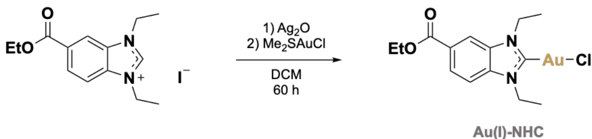
Figura 38 Esquema de reação para obtenção do complexo Au(I)-NHC . O complexo foi obtido por meio de uma reação de transmetalização usando o \text{Ag}_2\text{O} e o ligante NHC em diclorometano.
