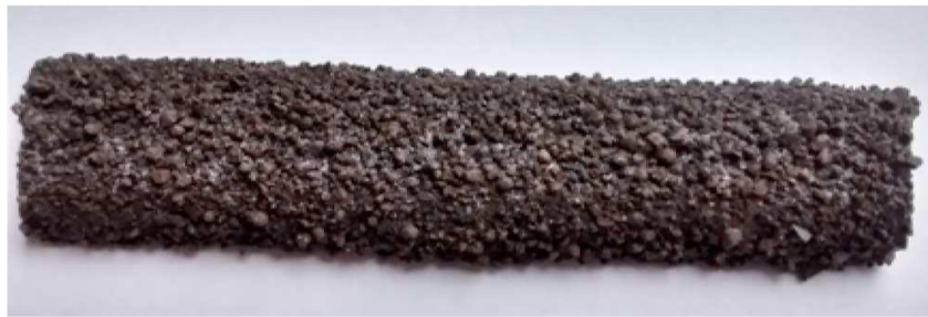
Figura 6 - Sobra de escória com fluxo aderido Fonte: Tecnologia da Soldagem, 2019
