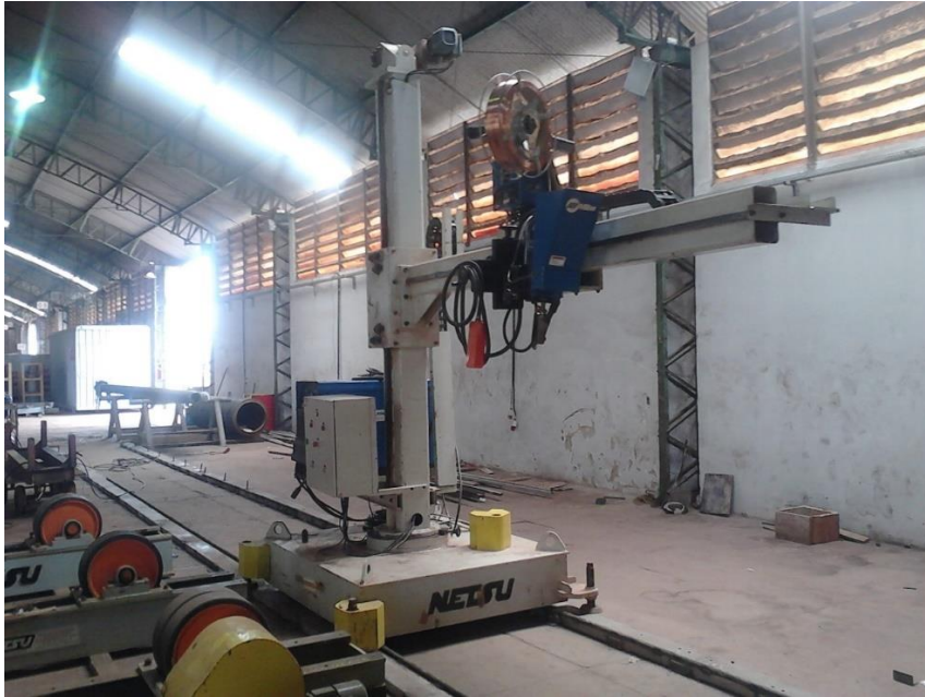
Figura 21 - Torre para máquina de solda, processo SAW utilizado para soldagem da tubulação Fonte: Milplan Engenharia
