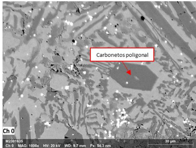
Figura 17 – Micrografia da região próxima a superfície, magnificação de 1000x, região (a).
