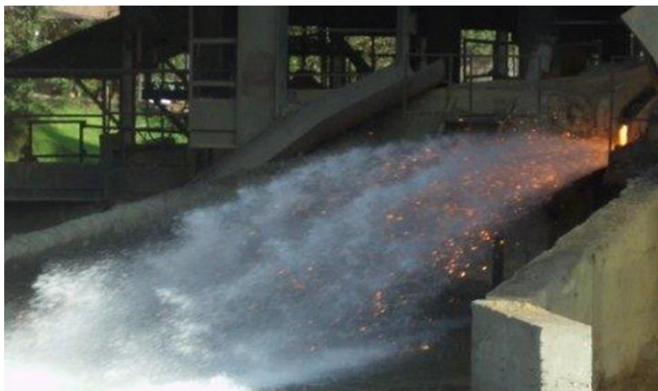
Figura 4 – Foto do processo de resfriamento brusco da escória de alto forno.
