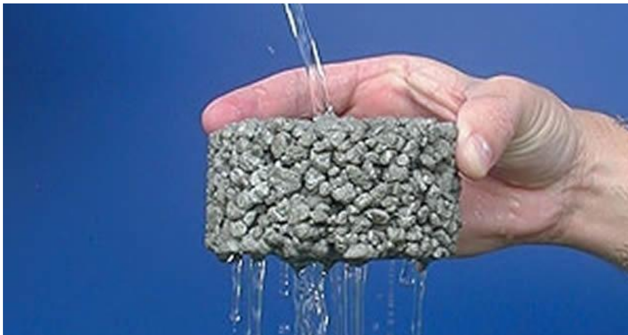
Figura 6 – Foto demonstrativa do processo de permeabilização do Pavimento de concreto
