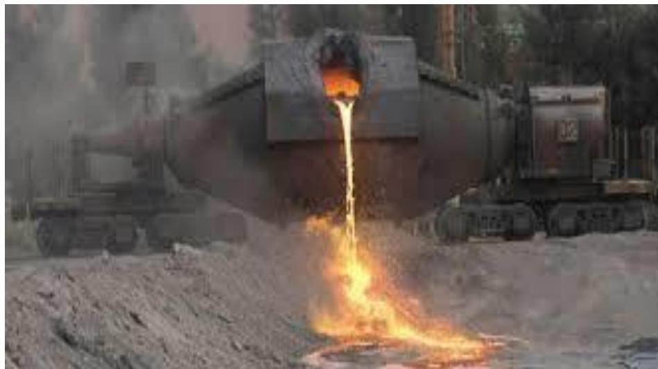
Figura 2 – Foto do processo de resfriamento lento da escória de altoforno.
