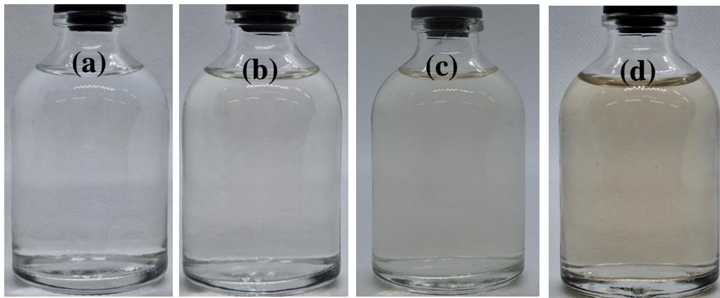
Figura 36 - Nanofluidos M1000_MW2 em força iônica 0,3 (a) 0,00% (b)0,25% (c)0,50% e (d)1,00%
