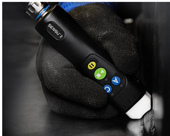
Figura 47 - Inspeção de junta soldada com uma sonda ACFM tipo caneta.
