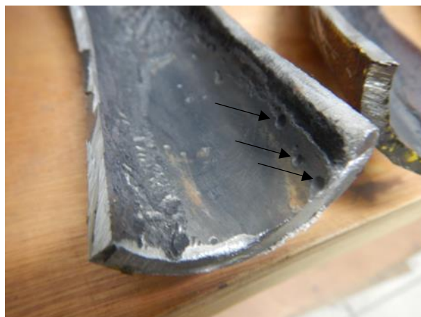
Figura 58 - Foto ilustrativa de uma curva inferior de um economizador sujeito a corrosão interna por pitting por contaminação da água de alimentação
