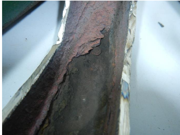
Figura 12 - Corrosão sob depósitos em curvas inferiores de um feixe de economizador de uma caldeira de recuperação anos após uma ocorrência de contaminação da água por licor preto.
