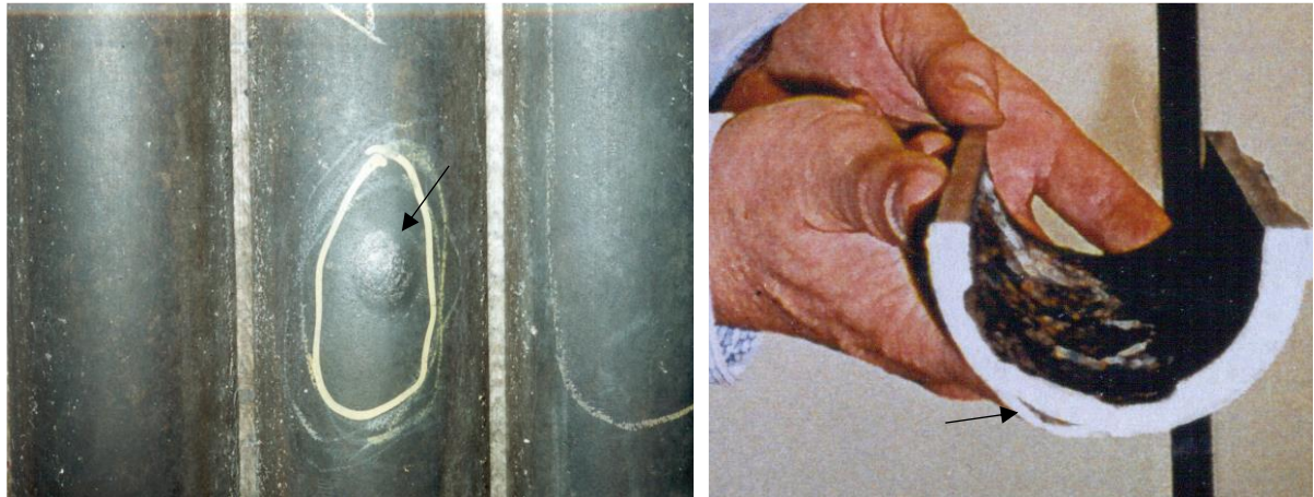
Figura 11 - Blister formado em tubo composto por dano por hidrogênio.
