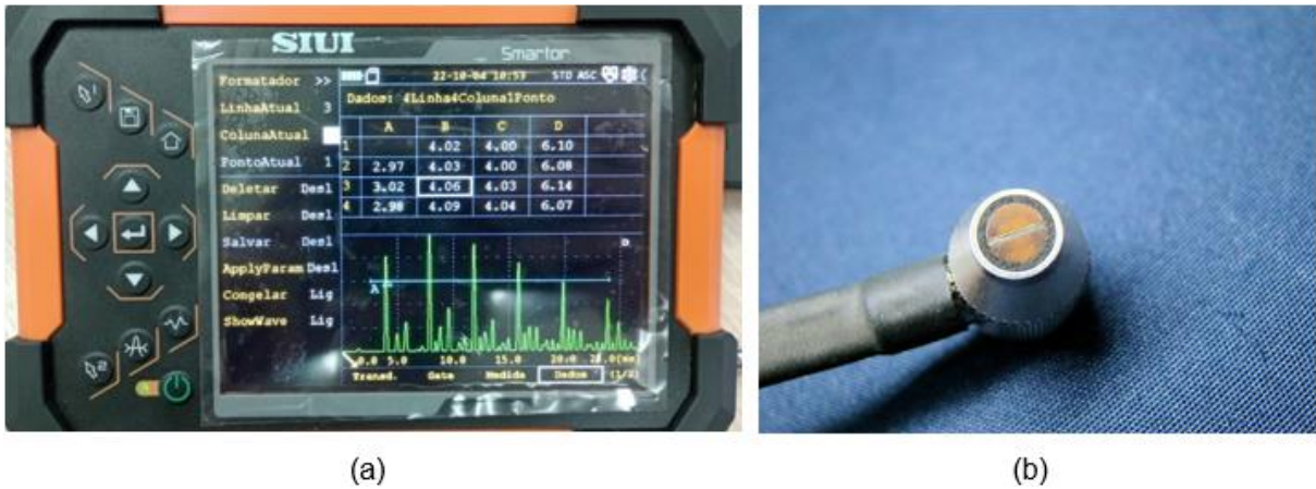
Figura 37 -Aparelhagem utilizada para medição de espessura em caldeiras: (a) aparelho de ultrassom com display A-Scan e (b) transdutor miniatura duplo cristal.
