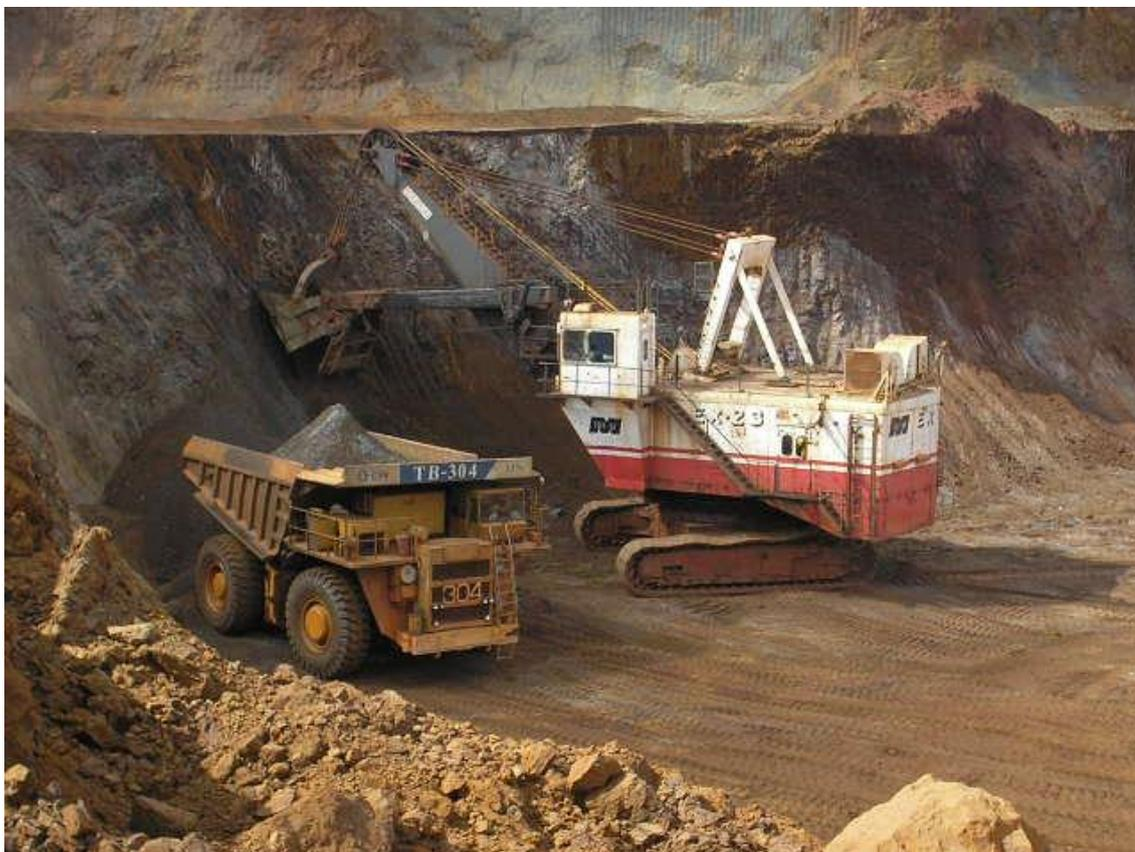
Figura 4.2 - Desmonte realizado por escavadeira hidráulica de forma mecânica.
