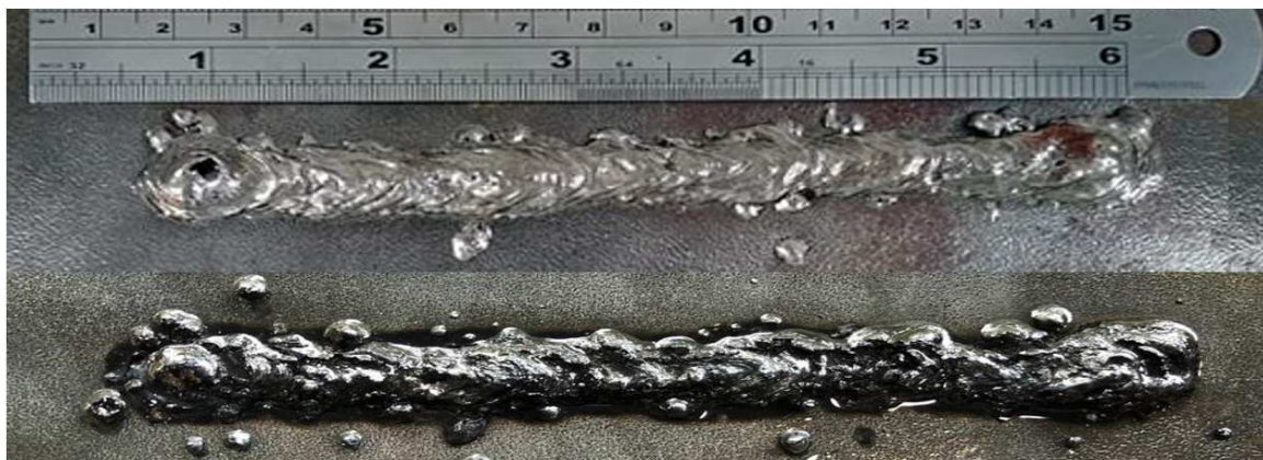
Figura 7. Aspecto Superficial del cordón de soldadura depositado.
